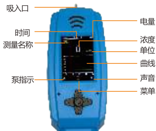
OT131 泵吸式结构示意图
